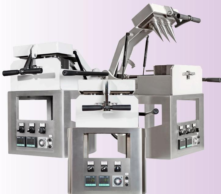
**I-conica light** è una macchina da banco di piccole dimensioni, con funzionamento meccanico manuale. Produce ad ogni cottura, 3 coni di wafer, in circa un minuto, utilizzando una normale presa elettrica 230V, presente in qualsiasi negozio.
